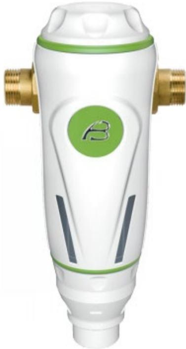
Per ottenere la certificazione PN16 (pressione massima 16 bar) le apparecchiature devono resistere alla pressione costante di 48 bar con periodo di 13 minuti e alla pressione dinamica di 200.000 cicli da 1.5 bar a 20.8 bar , con periodo di 4 secondi.(UNI 13443)
