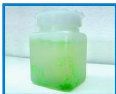
Negli impianti a bassa temperatura si sviluppano colonie batteriche e biomasse.
